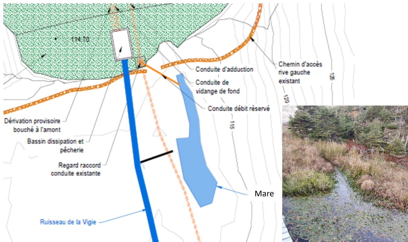
Figure 65: Vue du dispositif de débit réservé
